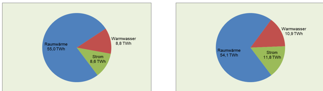
Abbildung 9: Energieverbräuche im Sektor Wohnen (links 1993/rechts 2017)
