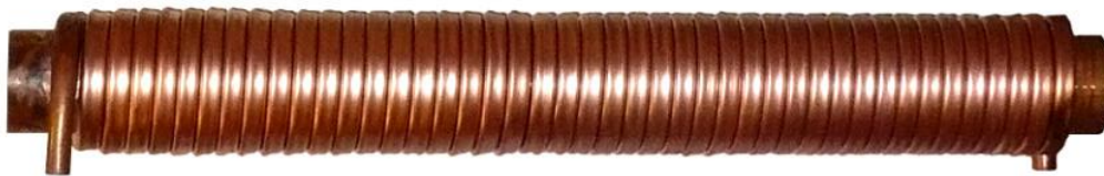
Joonis 4.8. Nn toru-torus soojustvaheti tüüp heitvee soojuste ärakasutamiseks. Heitvesi voolab ümber külma tarbevee torru
