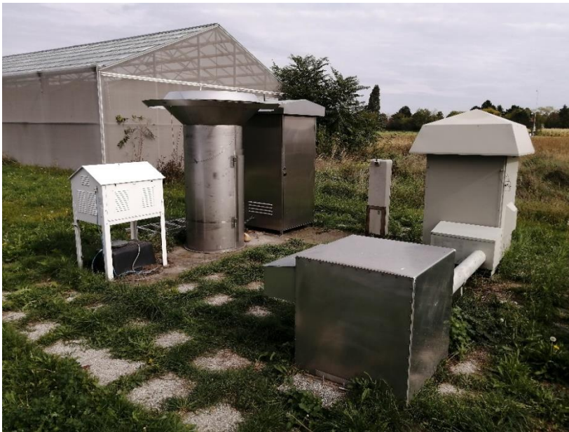
Abbildung 16. Einrichtung zur Luftprobenahme auf dem Laborgelände der AGES (von links: Kleinvolumen-Jodsammler, großer Depositionssammler, Mittelvolumen-Luftsammler und ein Großvolumen-Luftsammler)
