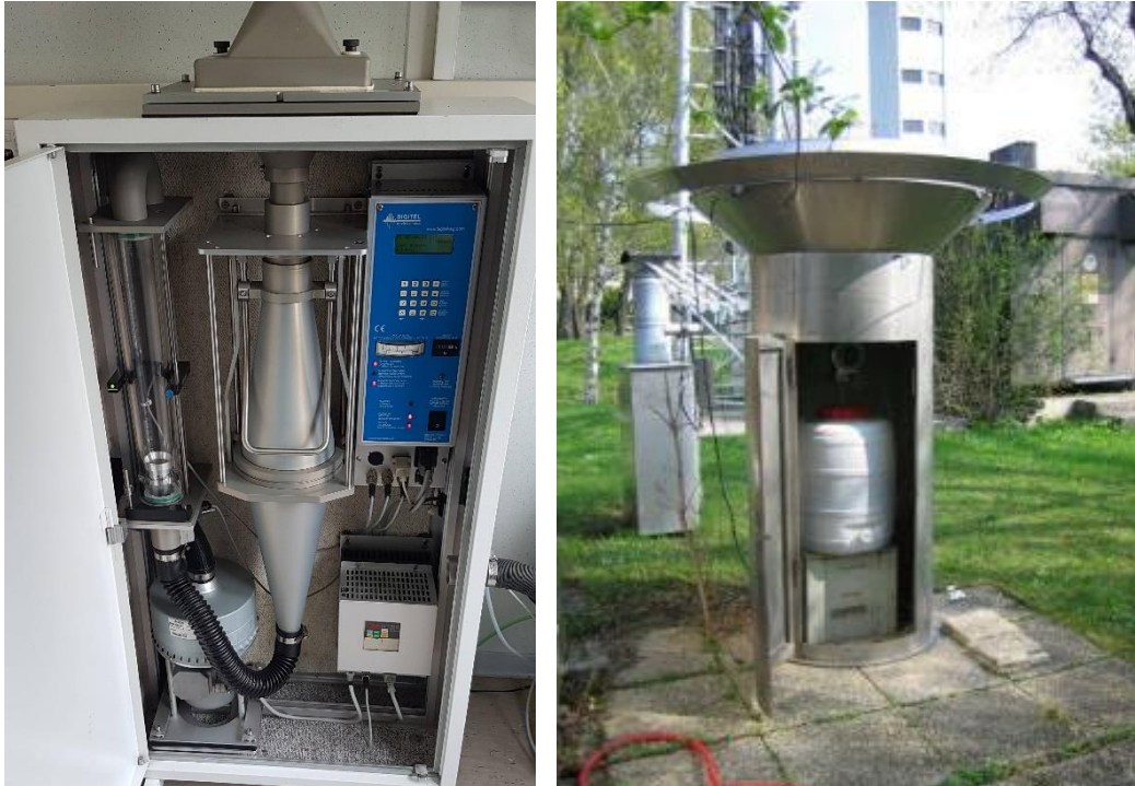
Abbildung 9. Links: Kaskadenimpaktor - Digital/ Tisch Environmental Inc.; Rechts: Großer Sammler für trockene/nasse Depositionen
