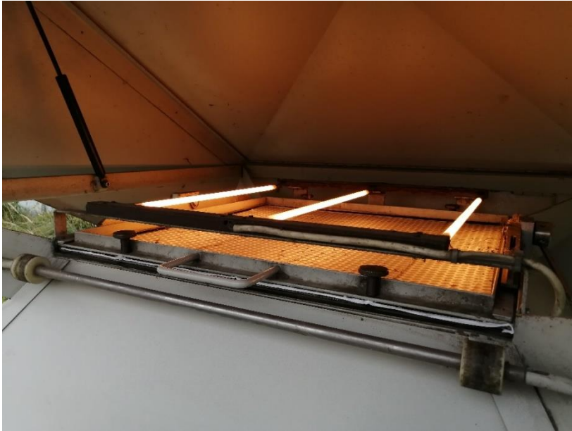
Abbildung 17. Großvolumen-Luftsammler mit Heizvorrichtung
