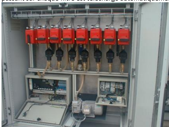
Figure 13 Échantillonneur d'air avec un filtre pour chaque jour de la semaine
