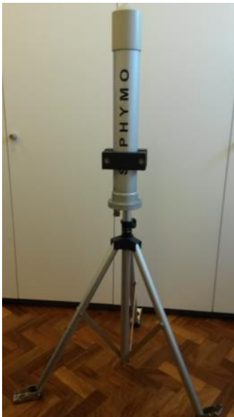
Figure 20 Sonde mobile automatique pour le débit de dose gamma
