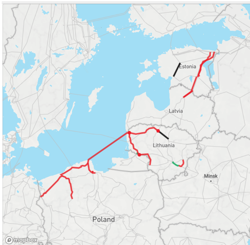
Joonis 11. Balti riikide elektrisüsteemi sünkroniseerimine mandri-Euroopa sagedusalasse 62 . Joonisel on kujutatud esialgne visand sünkroniseerimise plaanist ja hõlmab uuendatavaid liine.
