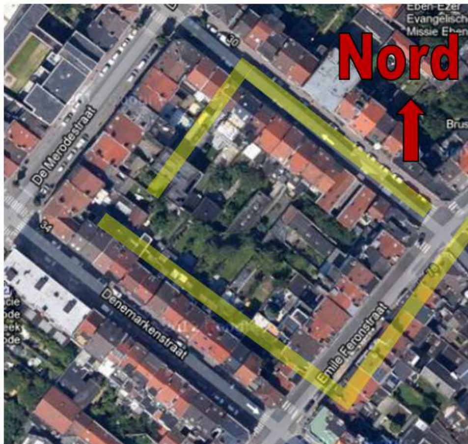
Figure 26 : Exemple de surface bien orientée pour les panneaux photovoltaïques (surface en jaune)
