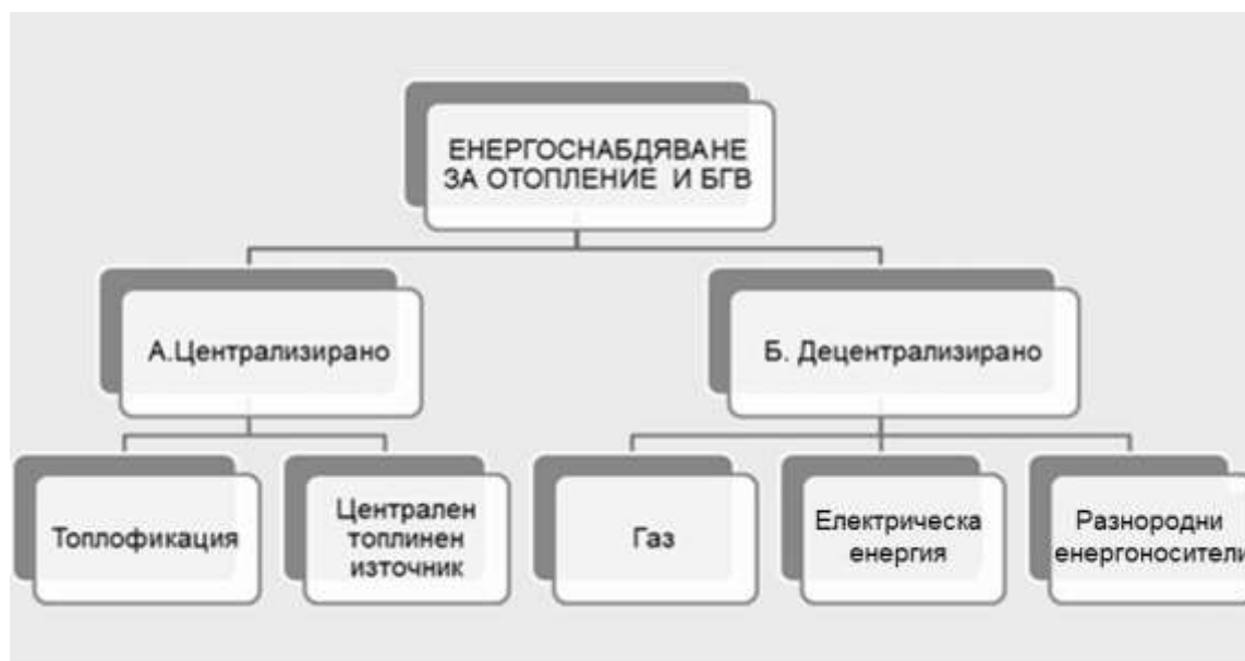
Фигура 1.2.2-7: Принципна схема 3 на класификацията на сградите по показател „вид на системата за топлоснабдяване“
