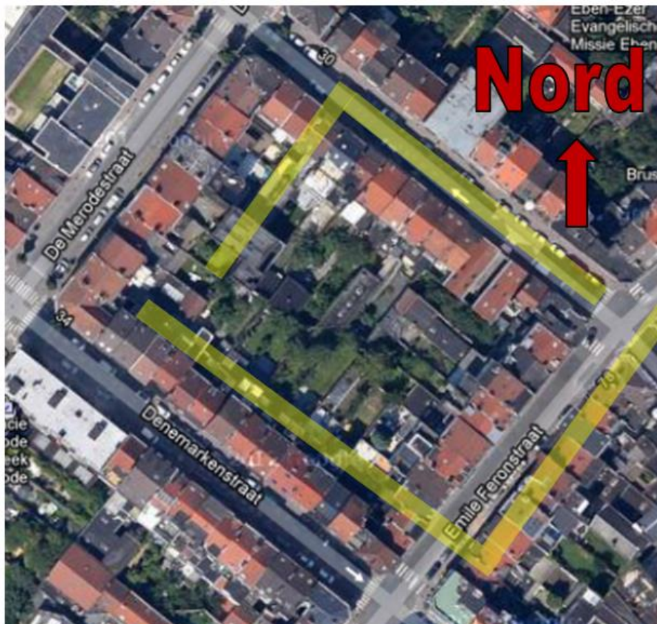
Figure 7 : Exemple de surface bien orientée pour les panneaux photovoltaïques (surface en jaune)
