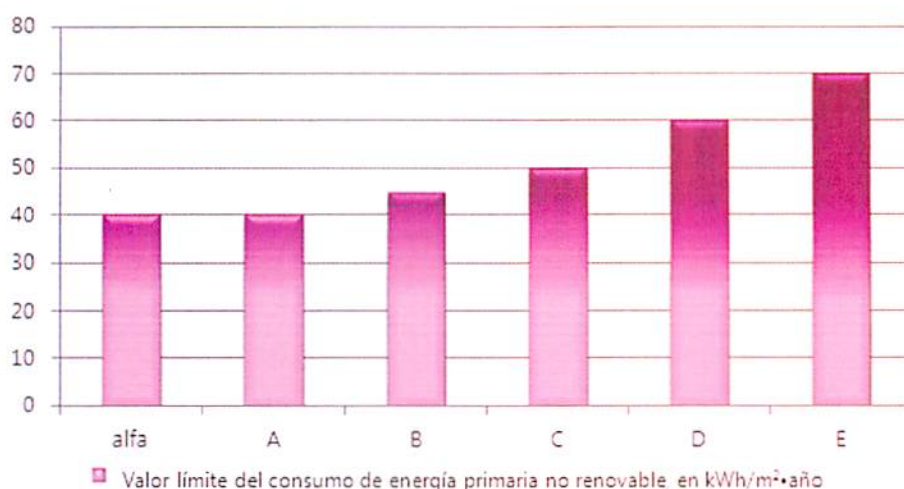
Figura 15. Límite de consumo energético de energía primaria no renovable para edificios nuevos o ampliaciones según DB HE 2013
