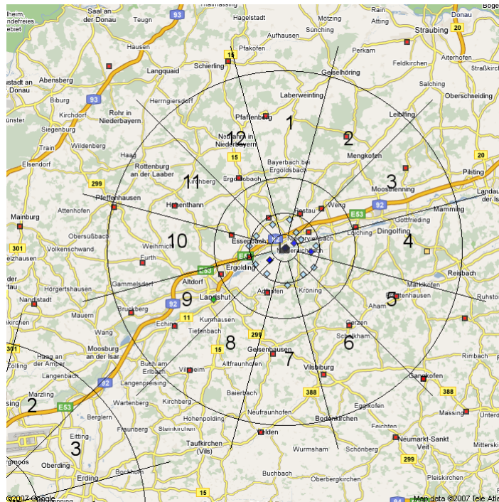
Abbildung 5: Kartenausschnitt um das KKI mit den Symbolen der im System ODIN integrierten Ortsdosisleistungsmessstellen.
