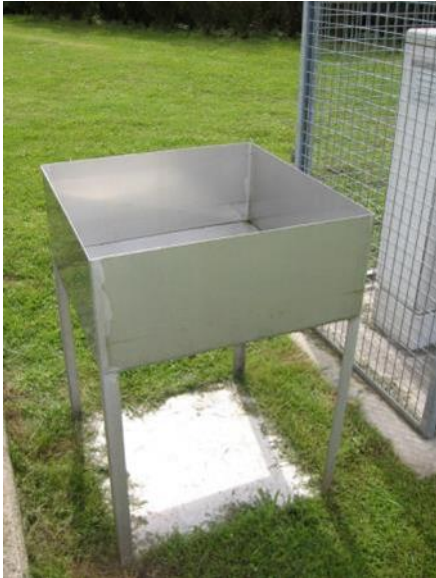
Abbildung 15. Sammelgerät für atmosphärische Ablagerungen
