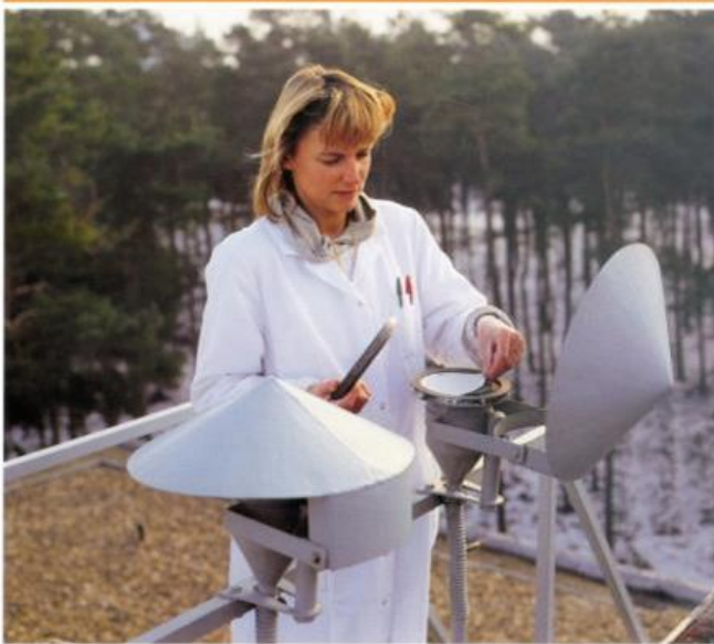
Abbildung 14. Luftprobensammler mit Einzelfilter
