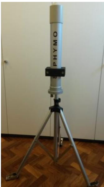
Abb. 20. Autark funktionierende mobile Messsonde zur Überwachung der Gammadosisleistung
