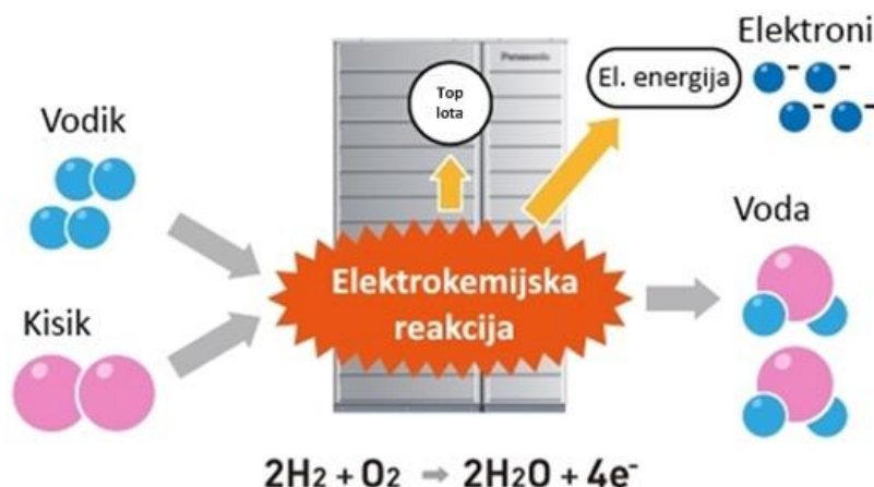
Slika 48: Shematski prikaz elektrokemijskega procesa v gorivni celici
